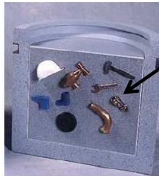
Les déchets radioactifs sont pris dans une matrice en béton dont les caractéristiques chimiques varient en fonction des déchets.
